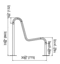
MODEL US-SF-A Plan & Side Elevation
