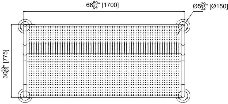
MODEL US-SF-A Plan & Side Elevation
